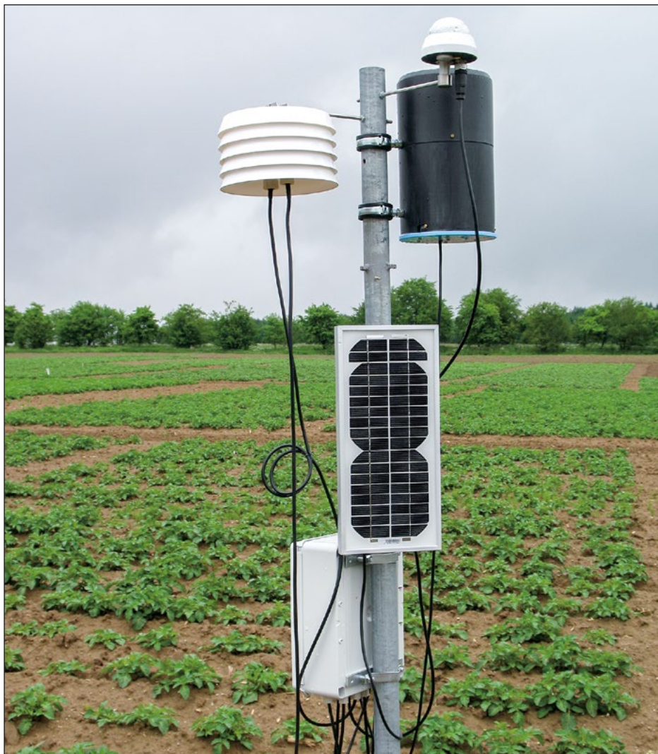
Obr. 14: Automatická meteorologická stanice pro sledování prognózy
